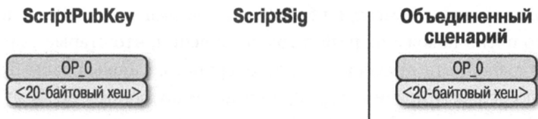
Рис. 13.3. Поля ScriptPubKey и ScriptSig для оплаты по хешу открытого ключа с раздельным заверением (p2wprkh)
