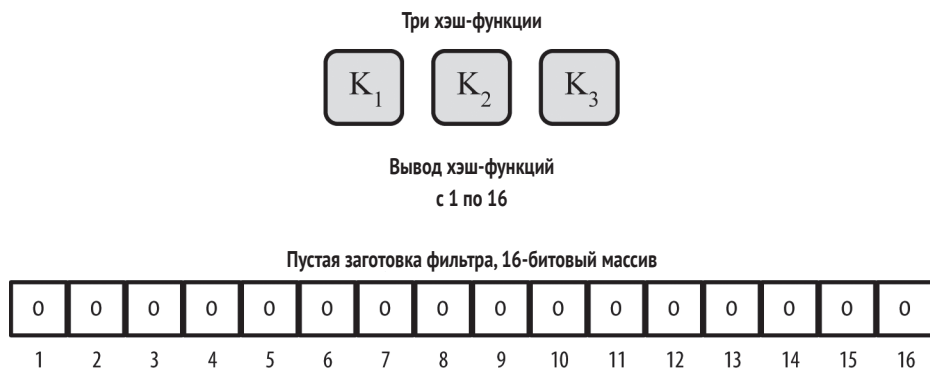
Рис. 8.8 ❖ Пример упрощенного фильтра Блума с 16-битовым массивом и тремя хэш-функциями
