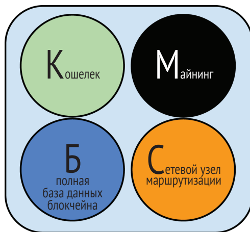
Рис. 8.1 ❖ Узел биткойн-сети с поддержкой всех четырех функций: кошелек, майнинг, полная база данных блокчейна и сетевая маршрутизация
