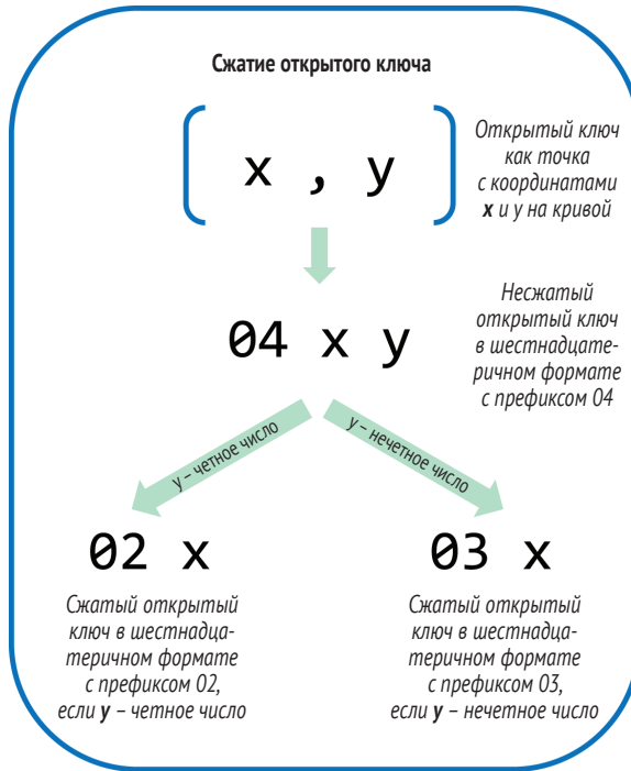
Рис. 4.7 ❖ Схема сжатия открытого ключа
