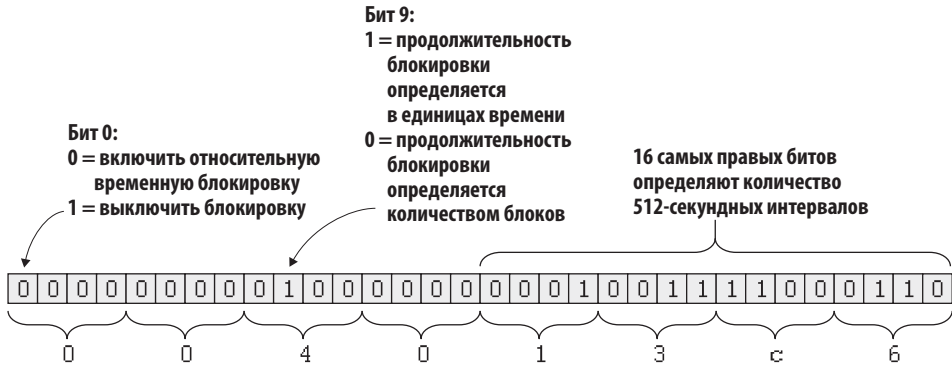
Рис. 9.6. Первый вход блокирует транзакцию, пока не пройдет 30 дней с момента подтверждения потраченного выхода
