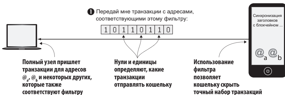
Рис. 6.16. Клиент посылает полному узлу фильтр Блума, чтобы замаскировать адреса, принадлежащие кошельку
