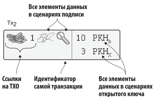
Рис. 6.20. Чтобы определить заинтересованность в транзакции, с помощью фильтра Блума проверяется несколько компонентов
