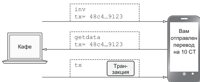
Рис. 8.17. Кошелек кафе получает транзакцию Джона от доверенного узла в кафе после ее сопоставления с фильтром Блума
