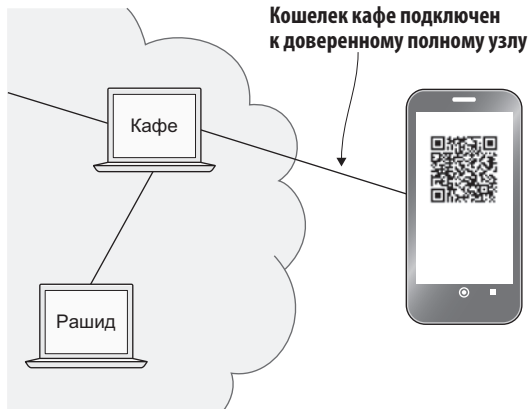
Рис. 8.16. Легкий кошелек в кафе подключается только к собственному полному узлу
