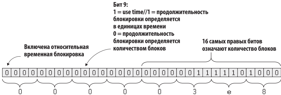
Рис. 9.7. Второй вход блокирует транзакцию, пока не будет найдено 1000 блоков после того, как был подтвержден расходимый выход
