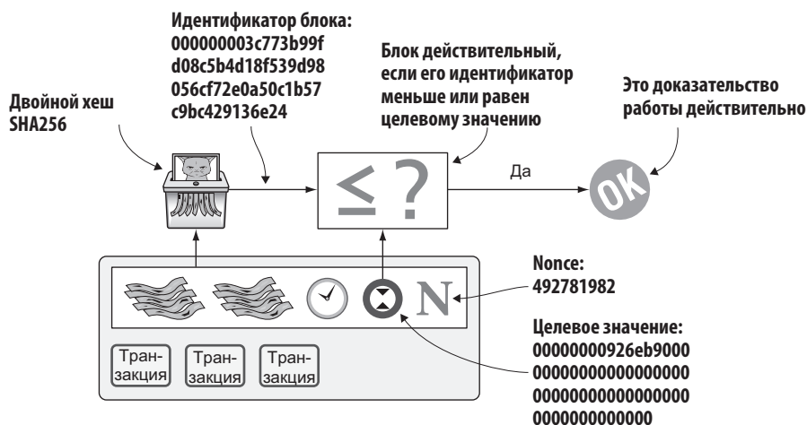
Рис. 7.11. Идентификатор блока должен быть меньше или равен целевому значению в заголовке. Иначе блок будет недействительным
