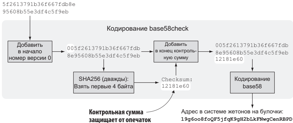
Рис. 3.13. Кодирование base58check хеша открытого ключа Джона. Сначала создается строка, включающая номер версии, хеш и контрольную сумму. Затем строка кодируется в формат base58
