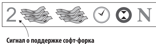
Рис. 11.19. Майнеры, выполнившие софт-форк, сигнализируют о поддержке новых возможностей изменением номера версии блока
