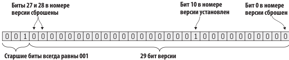
Рис. 11.21. Номер версии блока интерпретируется по-разному. Каждый из 29 битов справа может сигнализировать о поддержке разных предложений
