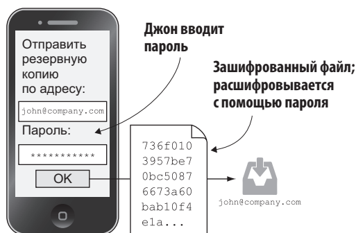
Рис. 4.6. Джон создает резервную копию своих закрытых ключей. Они записываются в файл, который затем шифруется паролем, который Джон вводит на своем телефоне
