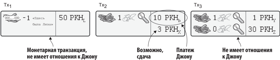
Рис. 6.18. Блок, выбранный для отправки, содержит три транзакции, но только одна имеет отношение к Джону
