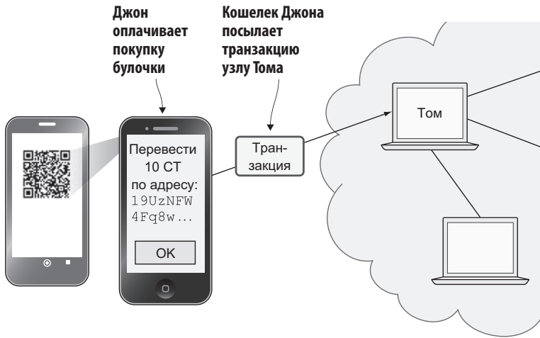
Рис. 8.11. Транзакция отправляется узлу Тома через TCP-соединение
