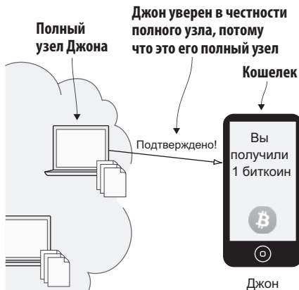
Рис. 6.32. Джон поддерживает свой полный узел, к которому подключен его легкий кошелек
