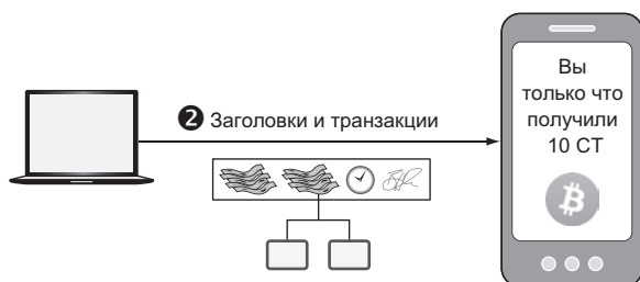
Рис. 6.22. Полный узел пересылает в кошелек заголовок блока и потенциально релевантные транзакции
