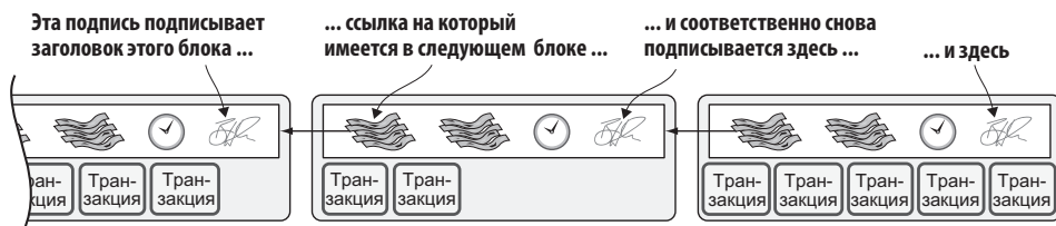
Рис. 6.14. Каждый блок одновременно подписывает все транзакции, созданные прежде, благодаря полю в заголовке с идентификатором предыдущего блока
