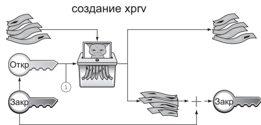
Рис. 4.18. Создание дерева хриб из главного хриб. Общий шаблон тот же, что и при создании хргv , но используется иная функция создания дочерних ключей
