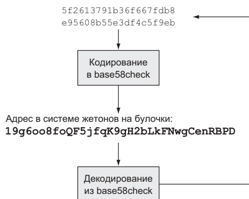
Рис. 3.11. Фаиза выполняет перевод на адрес Джона. Она декодирует адрес в РКН и проверяет отсутствие опечаток
