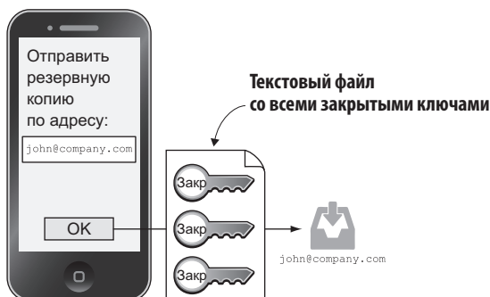
Рис. 4.5. Джон создает резервную копию своих закрытых ключей. Они записываются в текстовый файл, который затем отправляется на адрес электронной почты
